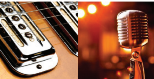
Een transducer zet energie van de ene naar de andere vorm om. Er bestaan verschillende soorten: elektrochemische (pH-meter), elektro-akoestische (microfoon, luidspreker), elektro-optische (fluorescente lamp) ...
